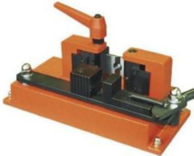
Praktisches, leicht zu bedienendes Gerät zum Abmanteln von Kabeln und Litzen bis 30 mm Außendurchmesser, mit Flachmessern auch für Flachkabel. Bedienung und Funktion Kabel zwischen die Messer einlegen, durch ziehen am Handhebel wird das Kabel festgeklemmt, die Messer schneiden ein, und die Isolation des Kabels wird abgezogen. Mit dem verstellbaren Anschlag kann die Abmantellänge genau eingestellt werden. Steckbare Messer gewährleisten ein sekundenschnelles Umrüsten auf verschiedene Kabeln.
