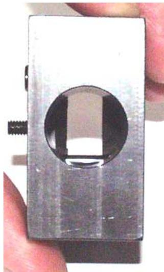
Innenansicht der Bohrung für das Druckstück
