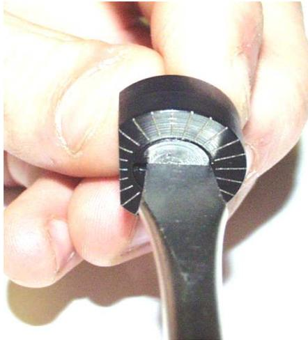
Crimphöhe mittels Schlitzschraube einstellen. Danach Innensechskantschraube wieder anziehen.
